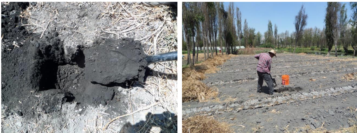
Figura 41. Técnica para la recolección de muestras con pala recta.
